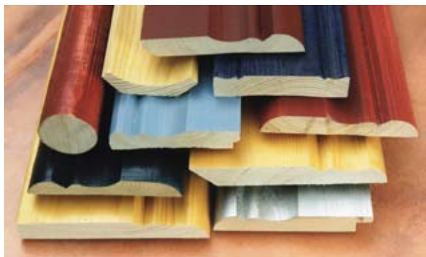
Certains des profils ci-dessus sont des exemples d'usinage où la scie a coupé entièrement à travers la pièce de bois.
